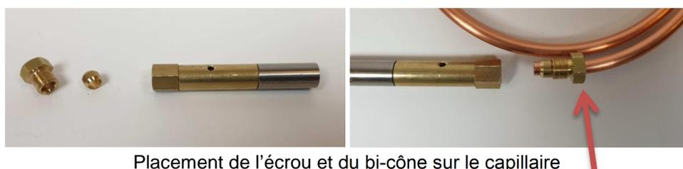
Placement de l'écrou et du bi-cône sur le capillaire
